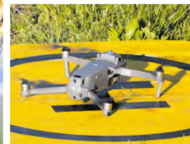
Hightech. Die Drohne ist mit einer hochauflösenden Wärmebildkamera ausgestattet, die minimale Temperaturunterschiede wahrnehmen kann.
